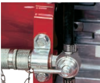
3-Wege Kraftstoffhahn Zum direkten Anschluss eines Betankungssystem.
